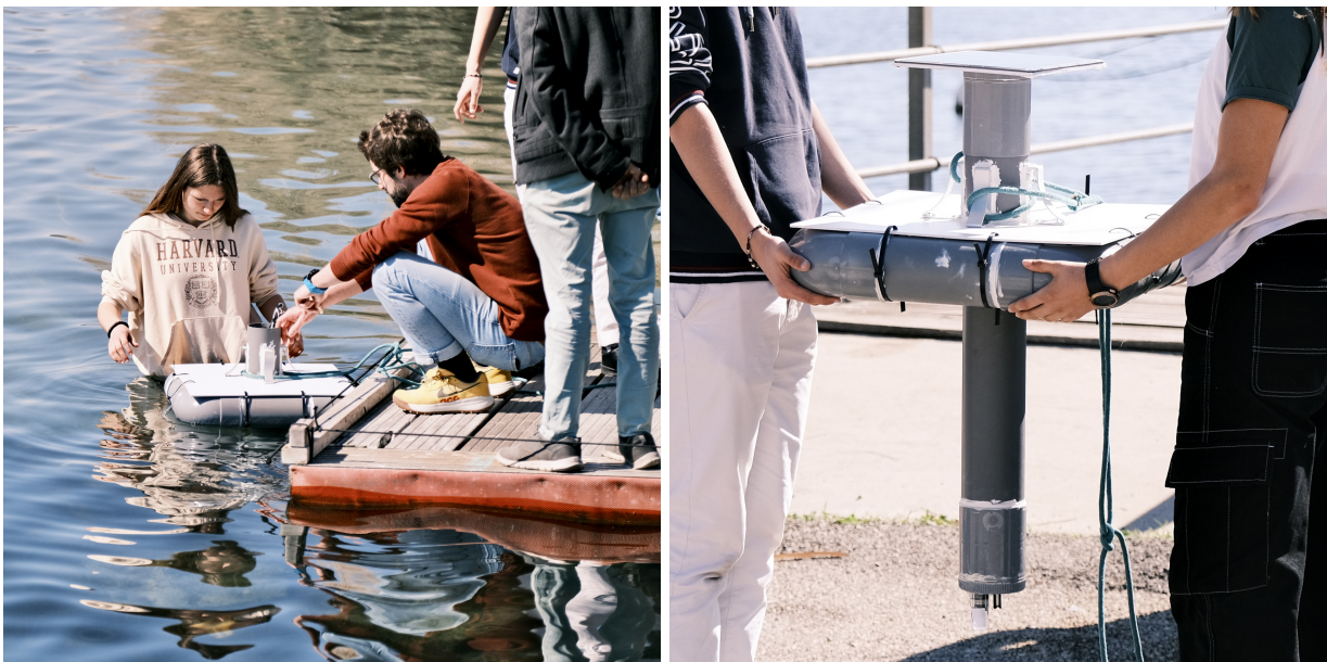
FIGURE 15 – Gauche : Test d'étanchéité et de flottabilité de la sonde. Droite : La sonde SEB complète, prête à être mise à l'eau !
