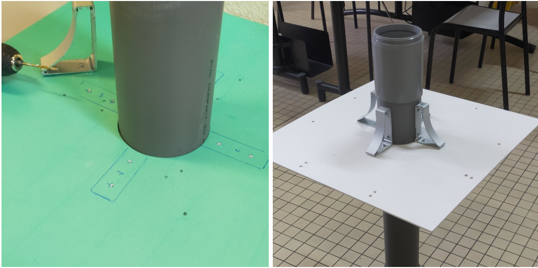
FIGURE 13 – Gauche : Détail lors du perçage de la plateforme pour fixer les équerres. Droite : La colonne de mesure fixée à la plateforme avec les 4 équerres vissées.
